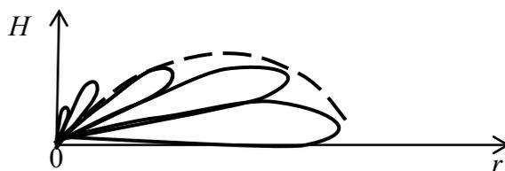
Рис. 3.27. Зона видимости РЛС в вертикальной плоскости
